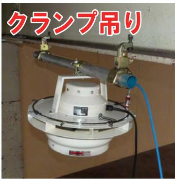
サークルミストは円形の本体周囲にミストノズル、内部にはファンが取り付けられています。噴出したミストをファンの風が広く遠くへ届けます。約40~60㎡(屋内)の範囲を冷却、加湿できます。
