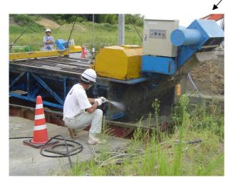
外部からの補給水用のホース又は、配管を外す。 タイヤ洗浄機本体内部の水を排出する。
