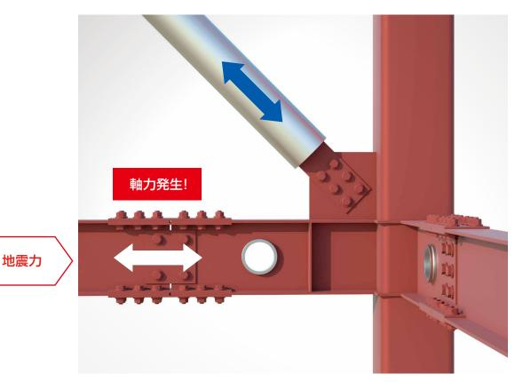
※梁に軸力が作用する場合とはブレース付きラーメン構造など、梁に作用する軸力を梁の断面算定において考慮する場合。
