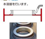
溶接はOSリング外周の全周す み肉溶接とし、溶接姿勢は水平 すみ肉溶接とします。
