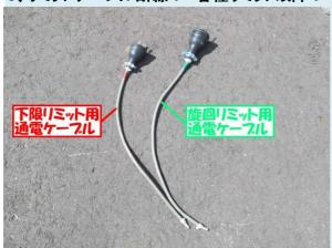
通電ケーブルをホイストから出ている リミットケーブルに差し替え下さい
