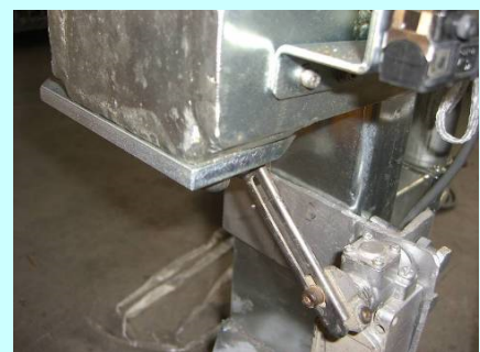
【荷台旋回リミット】・・・ハンドル爪部がシャトルフレームにロックされていなければ動きません。
