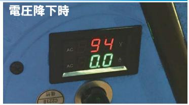
電圧: 94V(電圧降下している) 電流: 0.0 A を表示
