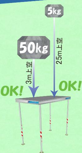
屋根面耐荷重: **95kg/m<sup>2</sup>**
