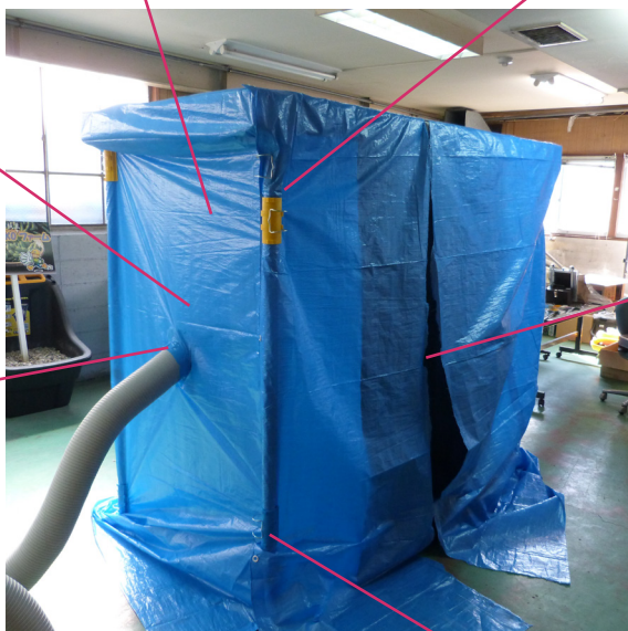
出入口用ブルーシート: 1.5 × 1K ※屋根に養生テープで止めています。 ※すいとる君使用時は、吸込み防止のため、内部に重りが必要。 ※この画像では解りやすくするために黒色のシートを使用しています。
