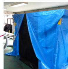
出入口用ブルーシート: 1.5 × 1K ※屋根に養生テープで止めています。 ※すいとる君使用時は、吸込み防止のため、内部に重りが必要。 ※この画像では解りやすくするために黒色のシートを使用しています。
