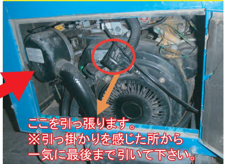
※リコイルにてエンジン始動、約10分ほど使用するとバッテリーがチャージ(充電)されます。エンジンスイッチを「OFF」にしてセルモーター(エンジンスイッチ)で再始動させる際に、リコイルスターターを使用しなくてもエンジンが掛かることもあります。
