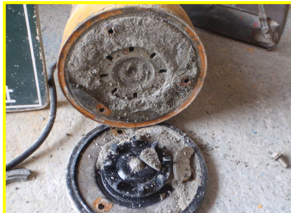
コンクリートの詰まり
