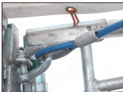
後方支柱にシャックル
