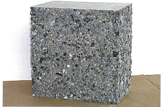
土木：打ち継ぎ面処理
