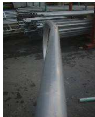
手摺 LTT-14 曲り不良 手摺 LTT-24 曲り不良
