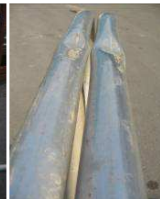
手摺 LTT-14 曲り不良 手摺 LTT-24 曲り不良
