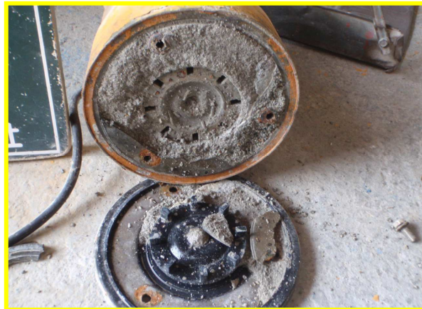
コンクリートの詰まり
