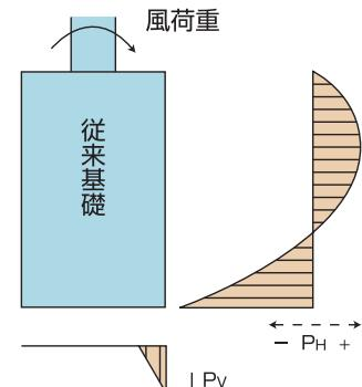
サットワン<sup>®</sup>は、軽量化により、側面への反力の負担が増して、基礎の寸法としては従来コンクリート基礎の寸法よりやや大きくなる場合がありますが、底面側に掛かる最大反力は従来コンクリート基礎の1/2~1/4程度に減少します。
