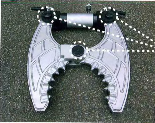
給油箇所 グリスアップ もしくは収納箱内の スプレーグリスの塗布
