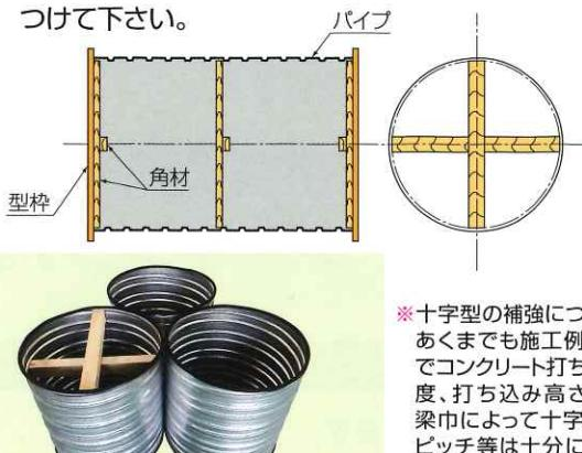
※十字型の補強については、あくまでも施工例ですのでコンクリート打ち込み速度、打ち込み高さ、口径、梁巾によって十字補強のピッチ等は十分にご検討の上、ご使用下さい。
